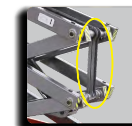
barre de sécurité maintenance
